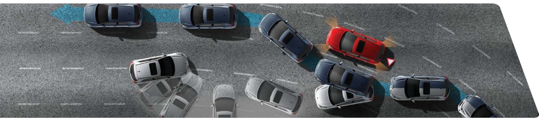
מערכת בלימה אוטונומית - AEB | מערכת התראה למניעת התנגשות קדמית - FCW | מערכת אקטיבית לסייע על שמירת נתיב הנסיעה - LKAS
