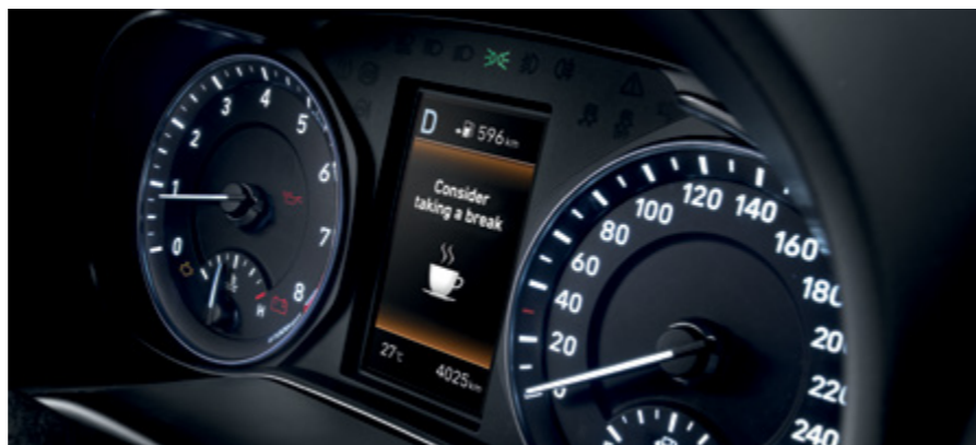
מערכת התראה על עירנות הנהג (DAW) התראה קולית ומסר כתוב המציע הפסקת ריענון להגברת הבטיחות במצבים של עייפות או חוסר ריכוז.
