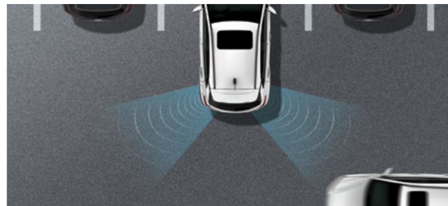
התראה על רכב חוצה מאחור (RCTA) רדאר אחורי הסורק בנסיעה לאחור ונותן התראה קולית על רכב שעומד לחצות.
