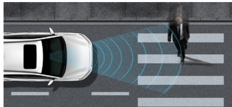
בלימה אוטונומית של הרכב במצבי חירום וזיהוי הולכי רגל עד 80 קמ"ש (AEB) שילוב של מצלמה ורדאר לזיהוי כלי רכב והולכי רגל, ועצירה אקטיבית של הרכב במצב חירום.
