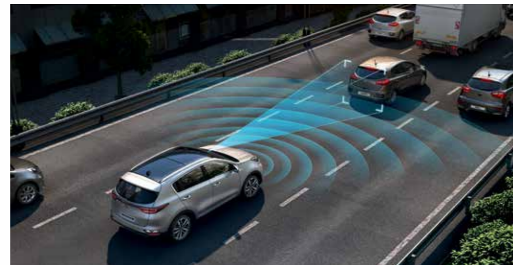
מערכת למניעת התנגשות קדמית ובלימה אוטונומית (FCA)
