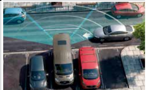
מערכת התרעת תנועה חוצה מאחור (Cross Traffic Alert)
