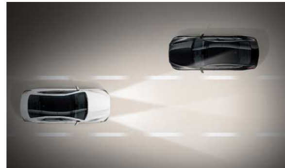
מערכת למעבר אוטומטי בין אור גבוה לנמוך (HBA) החלפה אוטומטית בין אור גבוה לנמוך בהתאם לתנאי הדרך, מונעת סינוור רכבים ומגבירה את הבטיחות בנהיגת לילה.
