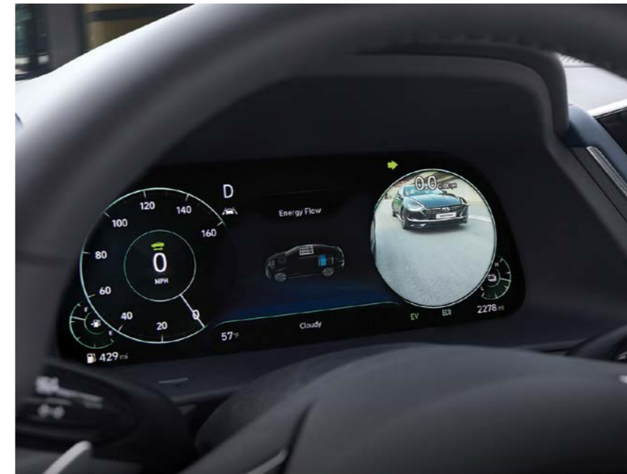
BVM הצגת צילום חי של "שטח מת" על גבי לוח השעונים הדיגיטלי בעת הפעלת איתות לצורך מעבר נתיב**
