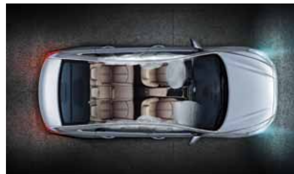
6 כריות אוויר 2 כריות אוויר קדמיות לנהג ולנוסע לצידו, 2 כריות אוויר צידיות לנהג ולנוסע לצידו וכריות וילון צידיות המגינות על הנוסעים מפגיעה במקרה של התנגשות.
