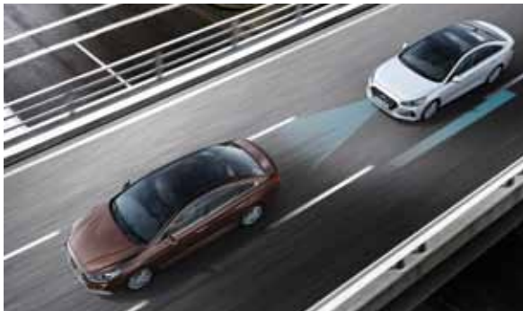
מערכת בקרת שיוט חכמה (ASCC) שומרת על מהירות ומרחק קבועים מהרכב שמלפנים באמצעות חיישן רדאר השולט בהאצה והאטת הרכב באופן אוטומטי.
