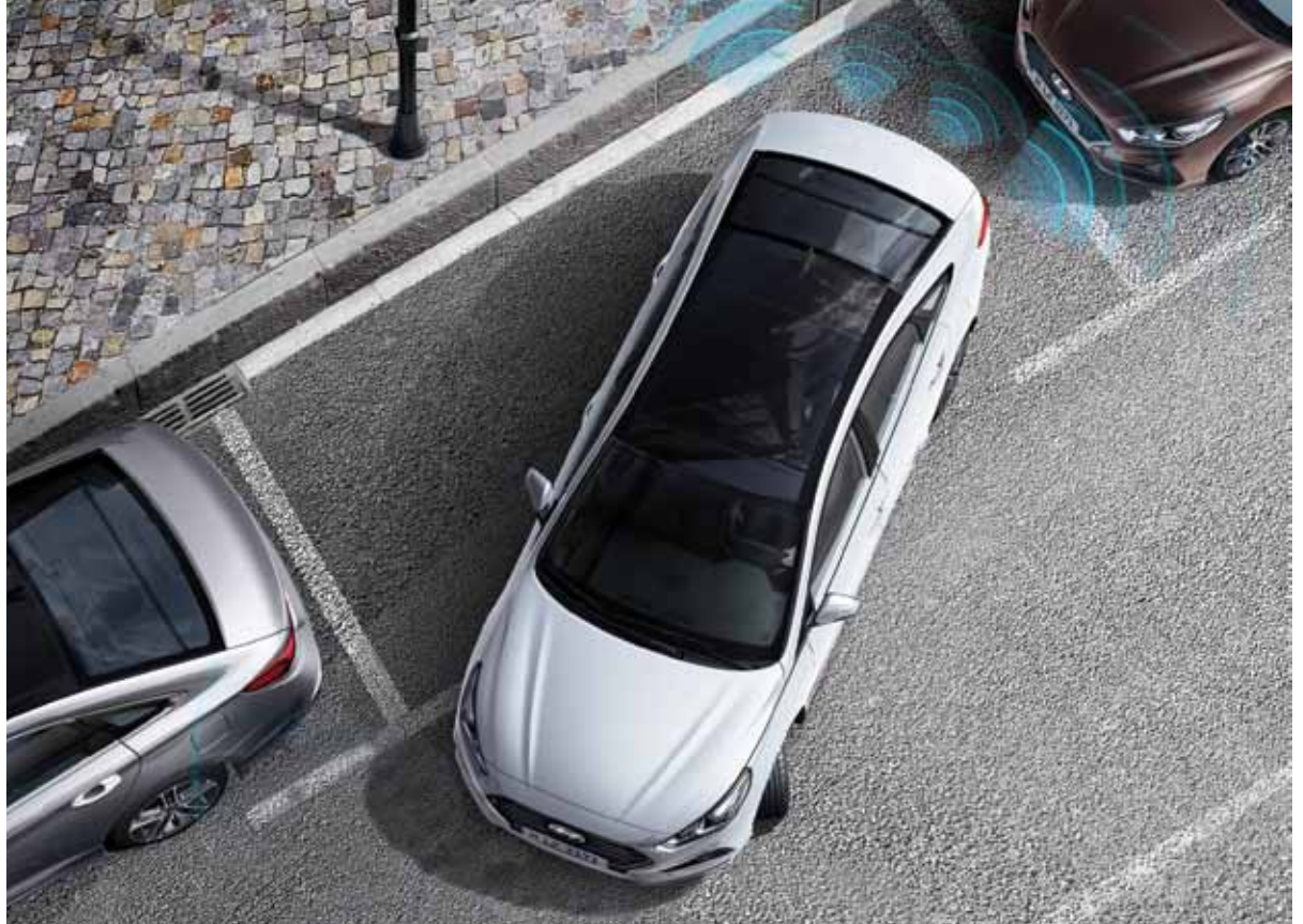
חיישני חניה אחוריים מקוריים (PAS) מסייעים לנהג בשעת חניה באמצעות התראה קולית כאשר הרכב מתקרב למכשול או לרכב אחר.
