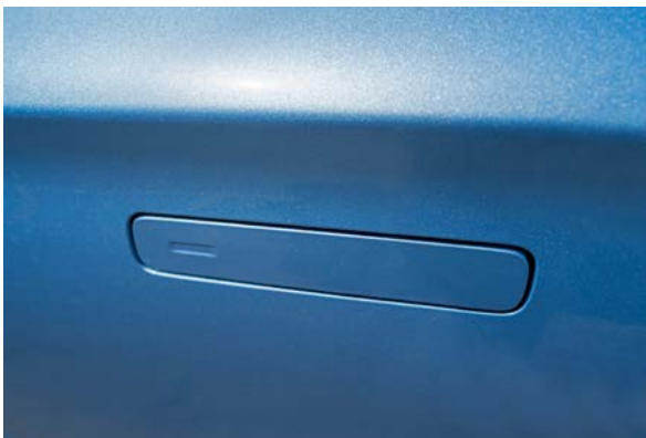
ידיות דלת נסתרות - ידיות הרכב נסתרות במהלך חניה ונסיעה. הידיות נפתחות החוצה בצורה אוטומטית בהתקרבות לרכב, ומתקפלות חזרה בהתרחקות ממנו.
