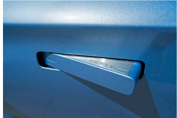
ידיות דלת נסתרות - ידיות הרכב נסתרות במהלך חניה ונסיעה. הידיות נפתחות החוצה בצורה אוטומטית בהתקרבות לרכב, ומתקפלות חזרה בהתרחקות ממנו.
