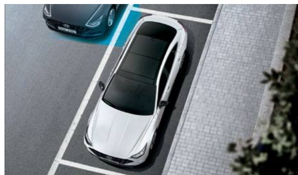
מערכת יציאה בטוחה מחנייה (SEA) מערכת "יציאה בטוחה" המתריעה ומונעת פתיחת דלתות המושב האחורי במקרה של רכב חוצה.
