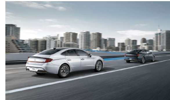
מערכת בקרת שיוט חכמה (SCC) שמירה על מהירות ומרחק קבועים מהרכב שמלפנים באמצעות חיישן רדאר השולט בהאצה והאטת הרכב באופן אוטונומי.
