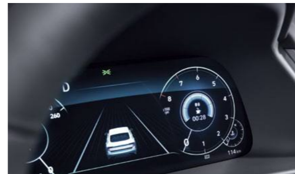
מערכת התרעה על עייפות הנהג/ת (DAW) מערכת המזהה סימני עייפות אצל הנהג/ת, מתריעה על כך וממליצה על הפסקת התרעננות.
