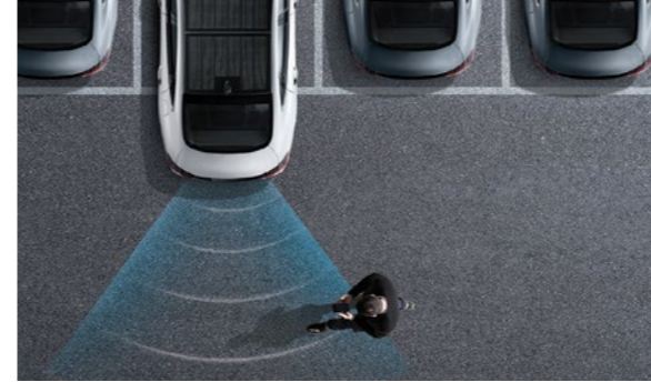
מערכת אקטיבית ליציאה בטוחה מחנייה (PCA) מערכת אקטיבית להתראה ומניעת התנגשות בעת כניסה ויציאה מחניה*.
