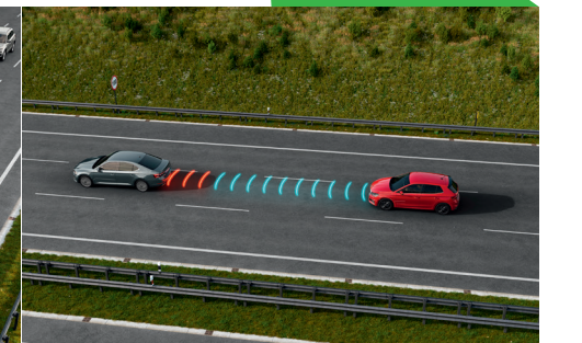
בקרת שיטן אדפטיבית Adaptive Cruise Control
