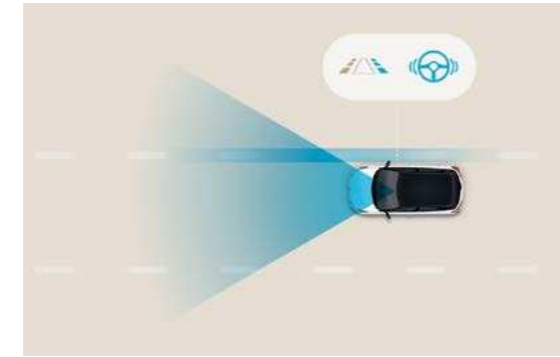
מערכת אקטיבית הכוללת תיקון הגה לסייע בשמירה על נתיב הנסיעה (LKA) סיוע אקטיבי בשמירה על נתיב הנסיעה, הכולל חיזוי בלוח המחוונים, התרעה קולית ותיקון אקטיבי של ההגה.
