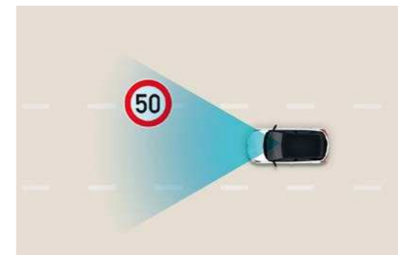
מגביל מהירות חכם (ISLA)* המערכת מאפשרת את הגבלת המהירות המקסימלית של הרכב בהתאם לתמרוני המהירות המוצבים בדרך.
