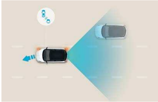
מערכת אקטיבית לזיהוי ומניעת התנגשות בעת מעבר נתיב (BCA)* מערכת מבוססת רדאר המתריעה על רכבים ב"שטח מת" ומבצעת תיקון אקטיבי בעת מעבר לנתיב שאינו פנוי.
