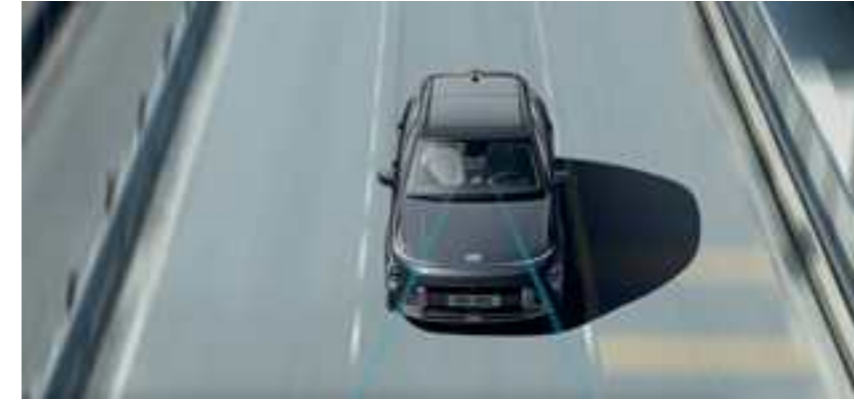
מערכת אקטיבית הכוללת תיקון הגה (LKA) מערכת אקטיבית הכוללת תיקון הגה לסיוע בשמירה על נתיב הנסיעה. כאשר המערכת מזהה סטייה מנתיב הנסיעה, היא מבצעת תיקון הגה אוטומטי בכדי למנוע את הסטייה מנתיב הנסיעה.
