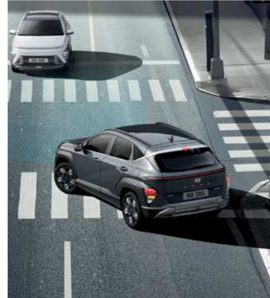
בלימה אוטונומית במצבי חירום (FCA-JT) מערכת אקטיבית המתריעה מפני סכנת התנגשות. במידה וסכנת ההתנגשות עולה לאחר ההתרעה, המערכת תבצע בלימת חירום אוטומטית. המערכת כוללת זיהוי כלי רכב, דו גלגלי ותנועה חוצה בצומת מכל הכיוונים.
