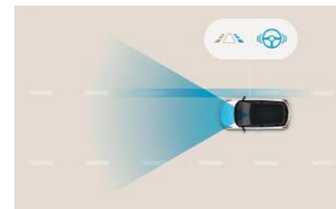
מערכת סיוע לשמירה על נתיב הנסיעה (LKA) מערכת אקטיבית הכוללת תיקון הגה לסיוע בשמירה על נתיב הנסיעה.
