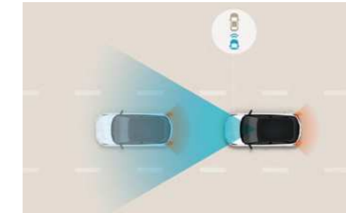
בלימה אוטונומית במצבי חירום (FCW) מערכת להתרעה מפני סכנת התנגשות, ובלימה אקטיבית של הרכב במצב חירום.
