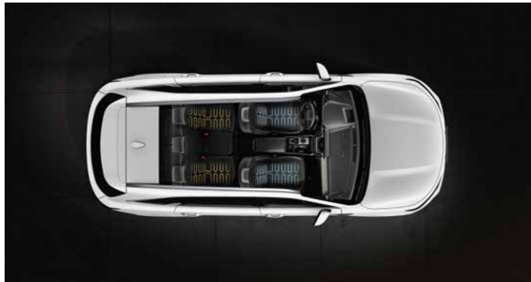
מושבים קדמיים עם חימום ואוורור* לימים חמים, מושב הנהג והנוסע כוללים חרירי אוורור בבסיס המושב ובמשענת הגב. לימים קרים, ניתן לחמם את הבסיס ומשענת הגב של המושב
