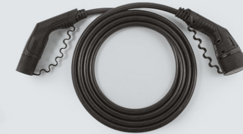
כבל טעינה MODE3 לעמדה טעינה ציבורית. חיבור Type2 - Type2 - מתאים לחיבור חד או תלת פאזי. - עד לזרם מקסימלי של 32A לקצב טעינה מקסימלי גם בעמדות הציבוריות.
