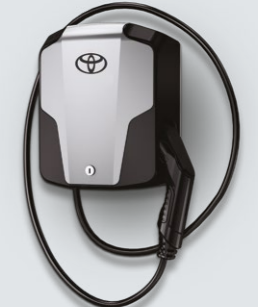
עמדת טעינה eMH1 - הפתרון הנוח ביותר של Plug & Charge לבית שלך. - העמדה מתאימה לחיבור חד או תלת פאזי, עד לזרם של 32A. - כוללת כבל טעינה מובנה מסוג Type2 באורך 6 מטרים. - בעלת הגנה מובנית מפני זליגת זרם DC. - הספק מקסימלי- 22KW
