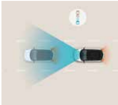
בלימה אוטונומית במצבי חירום (FCA) מערכת בלימה אוטונומית במצבי חירום הכוללת זיהוי הולך רגל, כלי רכב ודו-גלגלי.
