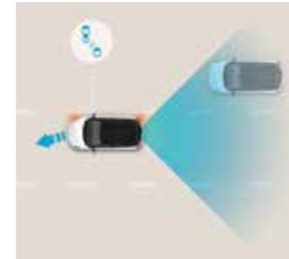
מערכת אקטיבית לזיהוי ומניעת התנגשות בכלי רכב ב"שטח מת" (BCA) מערכת מבוססת רדאר המתריעה על רכבים ב"שטח מת" בעת מעבר נתיב ומבצעת תיקון הגה אוטומטי במידה והנתיב אינו פנוי.
