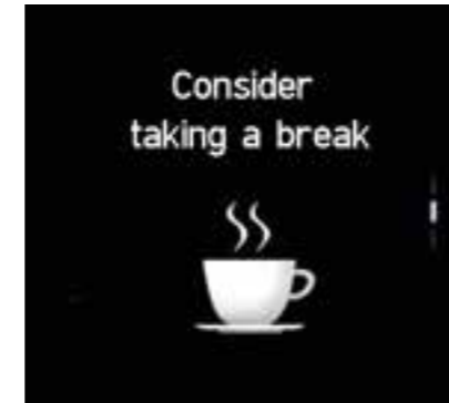
מערכת התרעה על עייפות הנהג/ת (DAW) מערכת המזהה סימני עייפות אצל הנהג/ת, מתריעה על כך וממליצה על הפסקת התרענונות.
