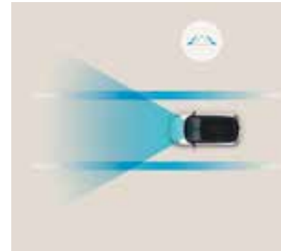
מערכת סיוע לשמירה על מרכז נתיב הנסיעה (LFA) מערכת אקטיבית המסייעת בשמירה על מרכז נתיב הנסיעה.
