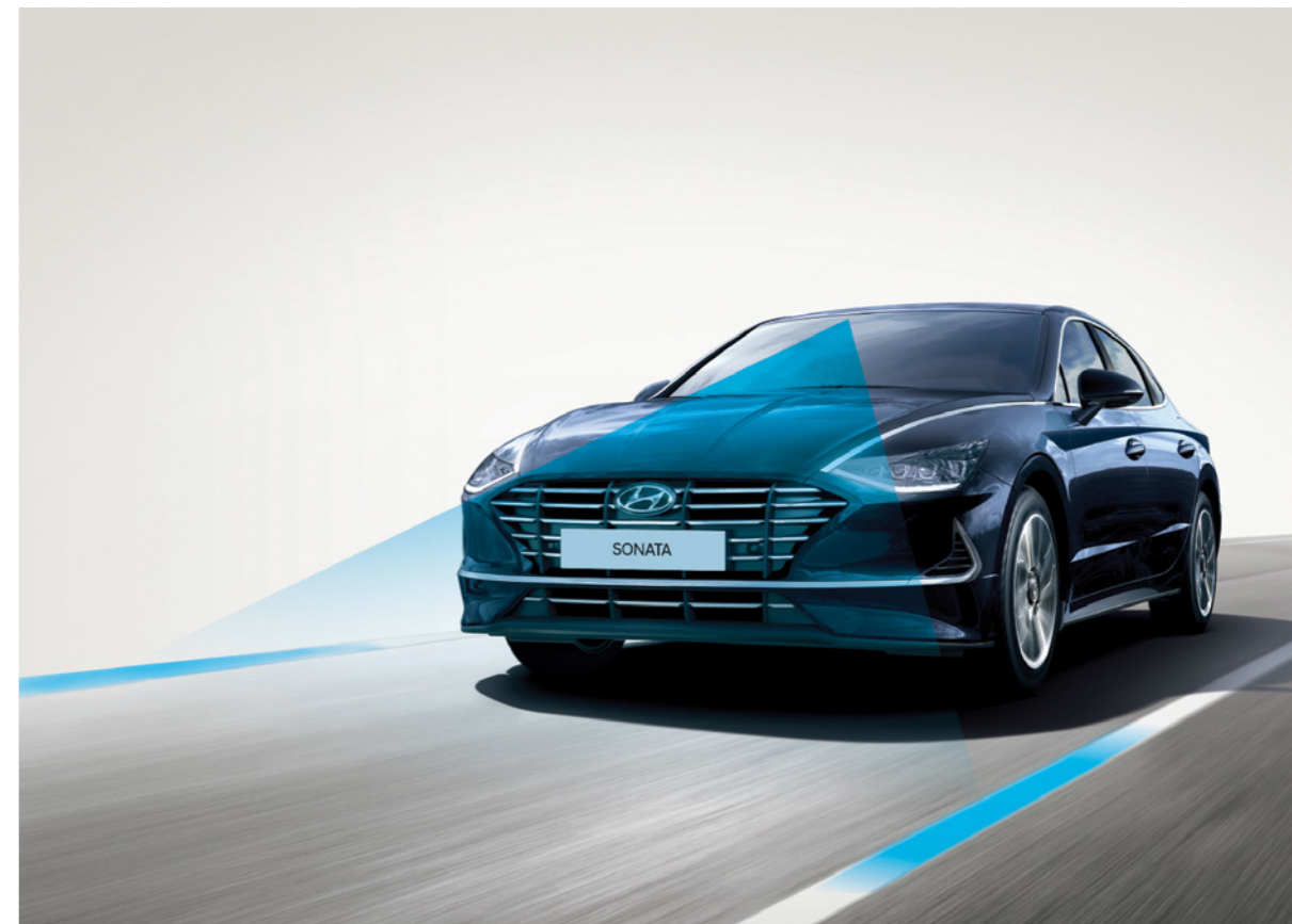
מערכת סיוע לשמירה על נתיב הנסיעה (LKA) מערכת אקטיבית הכוללת תיקון הגה לסיוע בשמירה על נתיב הנסיעה.
