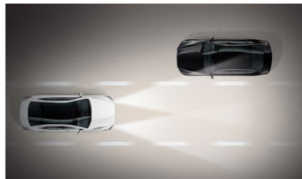
מערכת למעבר אוטומטי בין אורות גבוהים לאורות דרך (HBA) החלפה אוטומטית בין אורות גבוהים לאורות דרך בהתאם לתנאי הדרך, מונעת סינוור רכבים ומגבירה את הבטיחות בנהיגת לילה.
