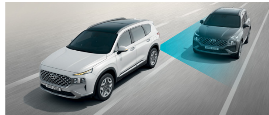
מערכת אקטיבית לזיהוי ומניעת התנגשות בכלי רכב ב"שטח מת" (BCA) מערכת אקטיבית למניעת התנגשות בעת מעבר נתיב המספקת התראה על רכב ב"שטח מת".*
