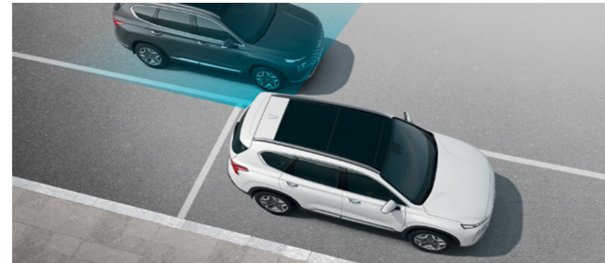
מערכת אקטיבית לזיהוי ומניעת התנגשות בכלי רכב ב"שטח מת" (BCA) מערכת אקטיבית למניעת התנגשות בעת מעבר נתיב המספקת התראה על רכב ב"שטח מת".*
