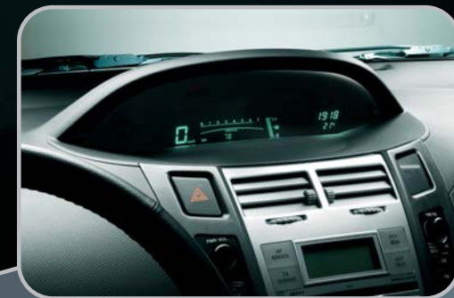
לוח מחוונים תלת מימדי דיגיטאלי המציג: טמפרטורה חיצונית, מהירות ממוצעת, שעון דיגיטאלי, צריכת דלק מיידית וממוצעת ומרחק נסיעה בהתאם לכמות הדלק שנותרה במיכל.
